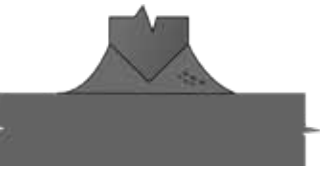
31 Porosity in Fillet (sub-surface) UT, RT
