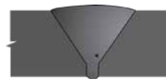
39 Porosity in Fillet (sub-surface) UT, RT
