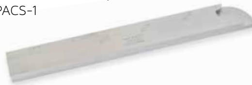
ISO 7963 Test Block #2 #ISO-TB-2
